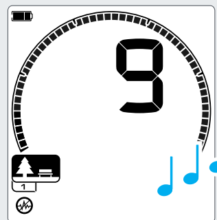
자동 노이즈 캔슬 완료. 자동으로 선택된 채널이 타겟 ID 디스플레이에 표시됩니다(예: 9)
